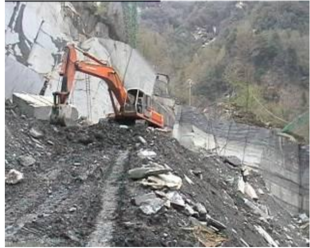
Foto IV.1.1 – Pala meccanica ed escavatore in cava
