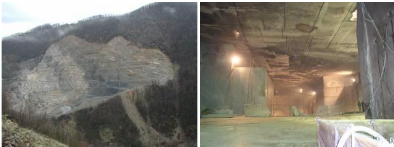
Foto III.1-2: Differenti contesti operativi: cava di inerti a giorno (sx) e cava di pietra ornamentale in sotterraneo (dx).
