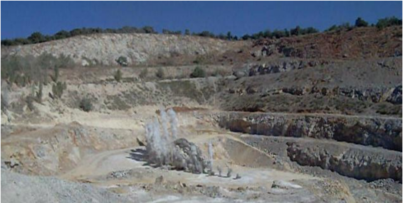
Foto VI.1.3.1 - Coltivazione della cava mediante esplosivo.
