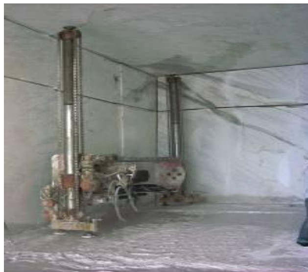
Foto IV.1.6 – Tagliatrice a catena su rotaia e tagliatrice a catena in postazione fissa su colonne
