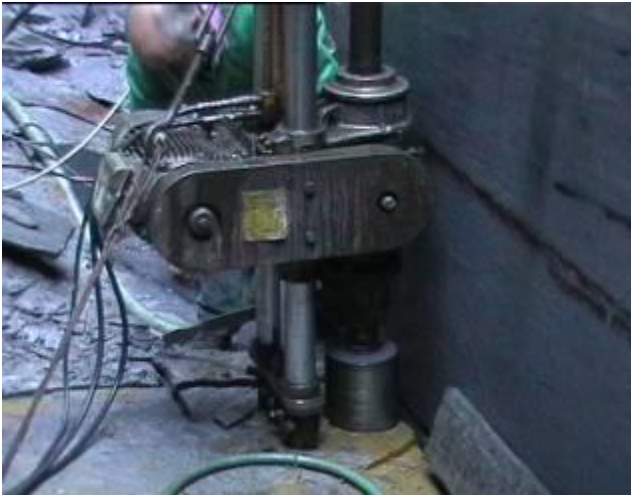
Foto IV.1.4 – Perforatrice a rotazione e parte di carota estratta
