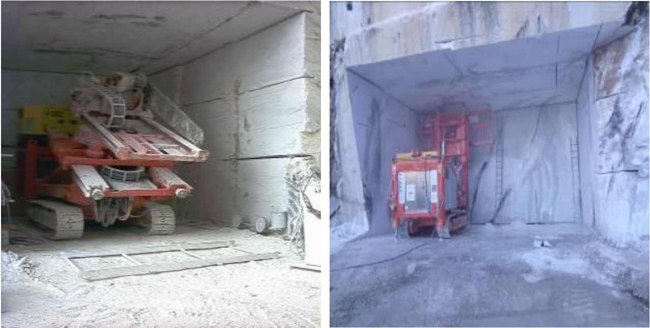
Foto IV.1.7 – Tagliatrici a catene semoventi : a riposo e in postazione di lavoro
