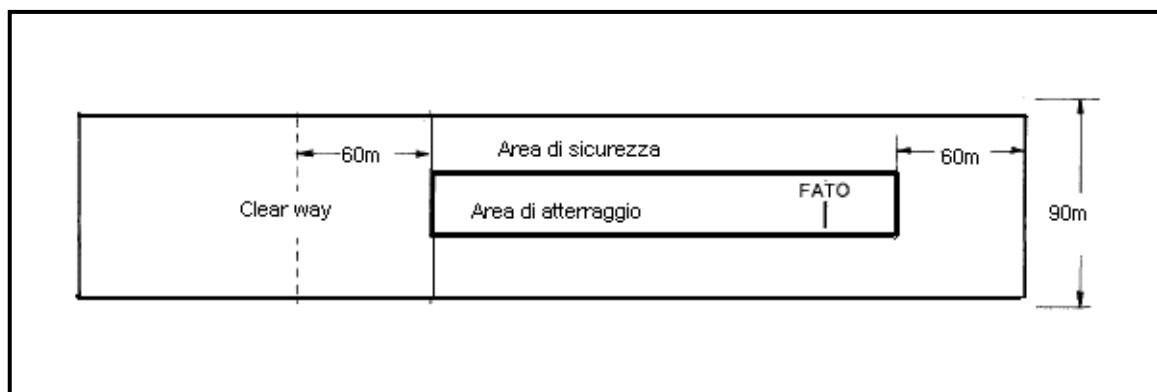
Figura 3-1 Area di sicurezza per operazioni strumentali
