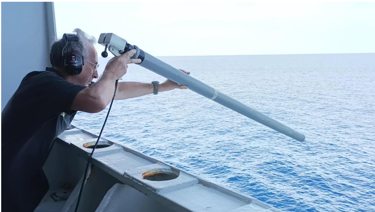
Figura 2 - Lancio sonda XBT
