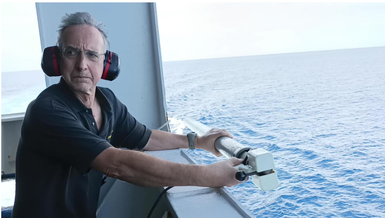
Figura 3 - Caduta della sonda XBT a causa della forza di gravità
