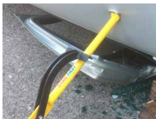
Con la parte a uncino allargare il foro fino a consentire l'inserimento del gancio.
