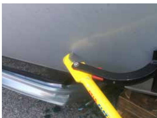
Scegliere una parte facile da incidere e facendo leva su un bordo usiamo la lama per tagliare la lamiera.
