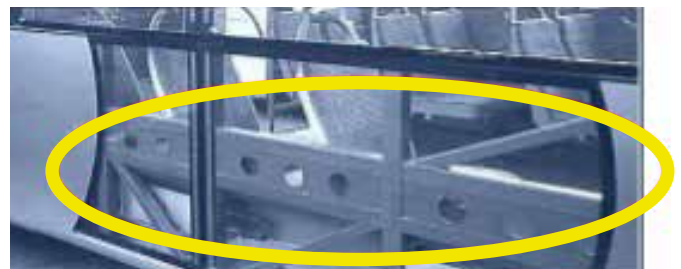
particolare del rinforzo laterale
