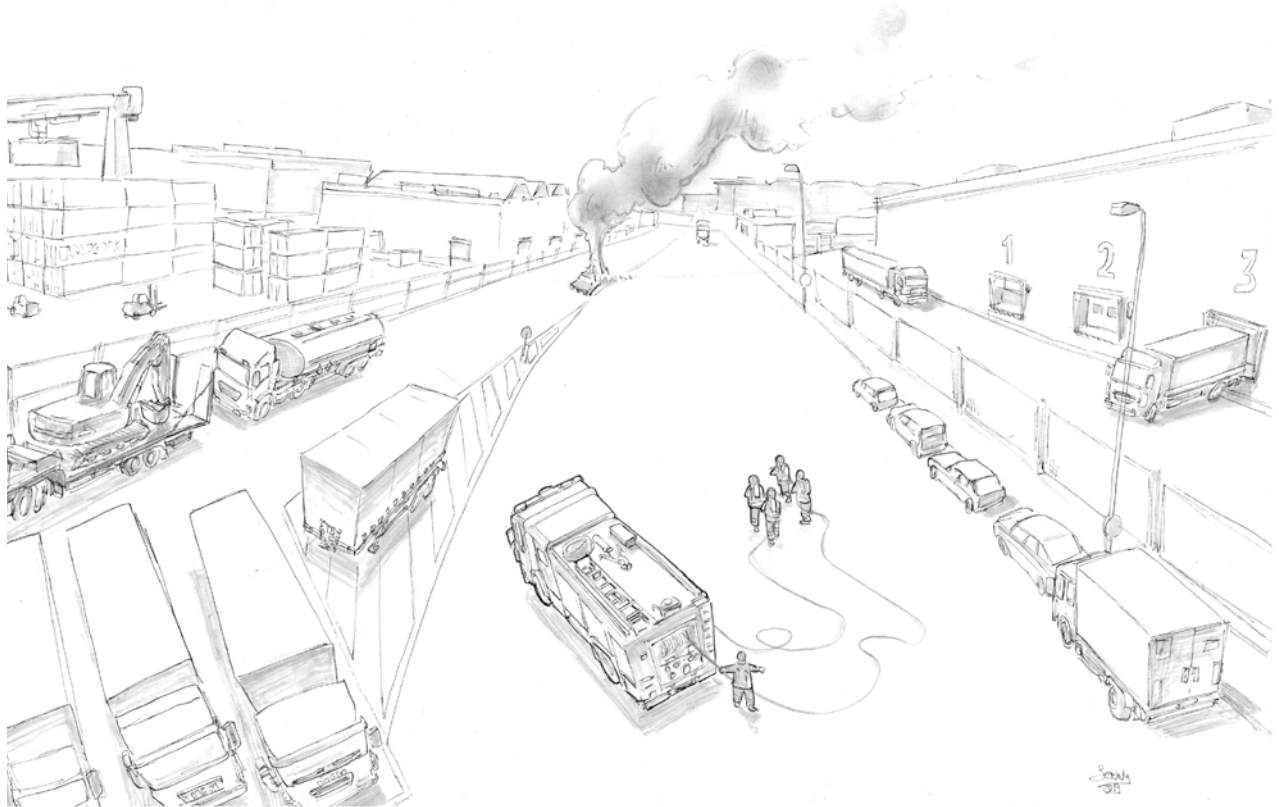
Non superare il veicolo in fiamme e posizionare l'APS a una distanza di sicurezza adeguata allo scenario e stendere 2 tubazioni. I due binomi avanzano iniziando a erogare l'acqua a getto pieno.
