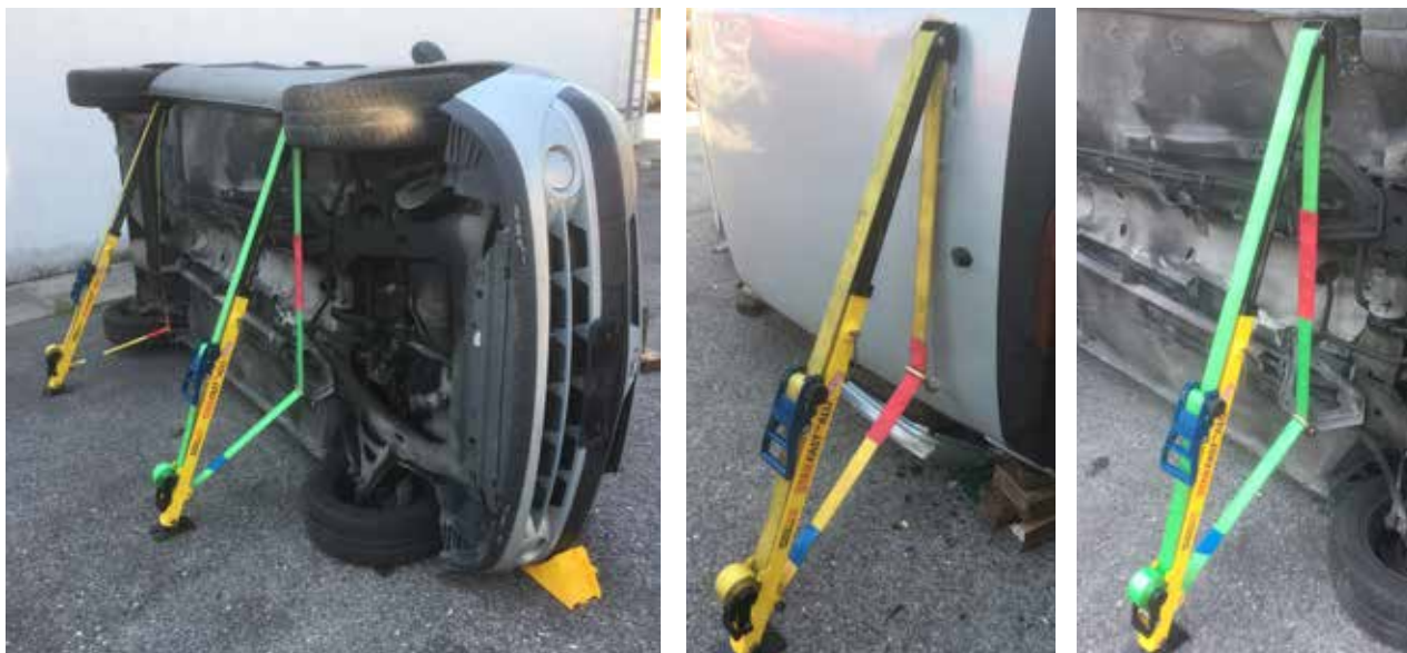
Nelle foto gli stabilizzatori vengono collocati su un unico lato: per la conformazione dello scenario o per una scelta strategica
