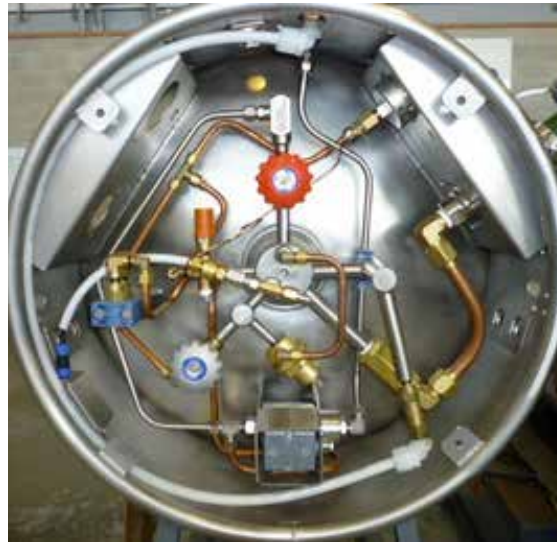
gruppo valvolare (mv) serbatoio LNG ECE-ONU R110
