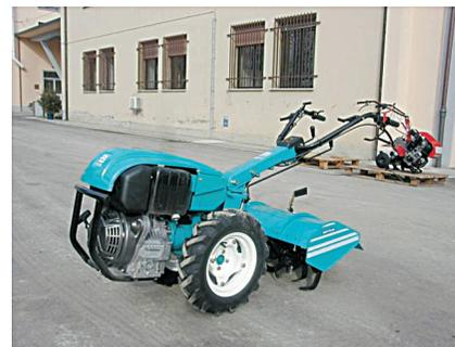
I motocoltivatori e le motozappatrici sono macchine destinate alla lavorazione del terreno con conducente a piedi. Nel momento in cui sono abbinate ad un carrello e l'operatore è trasportato si configurano come motoagricole e pertanto devono rispettare tutti i requisiti ad esse applicabili (es. cinture e telaio di protezione)
