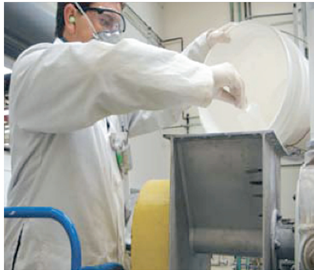
Un lavoratore addetto alla produzione di nanoparticelle, durante un'operazione di colata, indossa un campionatore personale, dispositivi di protezione dell'udito, delle vie respiratorie e dermici.
