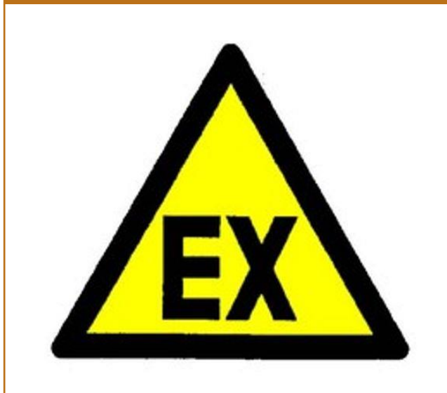
Figura 1 Segnaletica indicante una zona con possibile formazione di un'atmosfera potenzialmente esplosiva.
