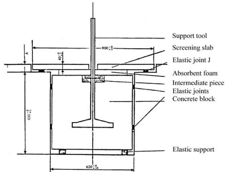
Il valore di A è tale che la lastra poggiante sul giunto elastico J sia a livello con il suolo.
