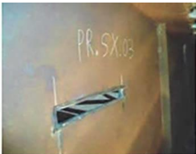
Prelievo di un campione di una trave principale
