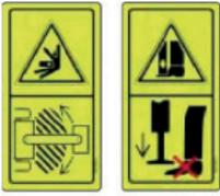
*Esempio di pittogrammi richiamanti l'attenzione sui rischi connessi all'accoppiamento ed al disaccoppiamento della macchina alla trattore*
