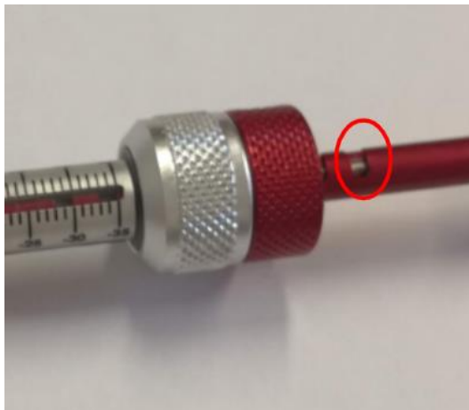
Figura 3.18 - Rotazione del pistone per bloccare il movimento lungo l'asse della fibra.
