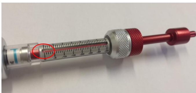
Figura 3.19 - Allineamento del pistone con lo zero della scala graduata.
