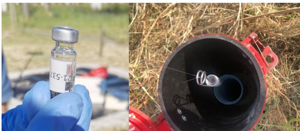
Figura 3.2 - Campionatore WMS-SE, che nel suo alloggiamento metallico viene calato all'interno della sonda.
