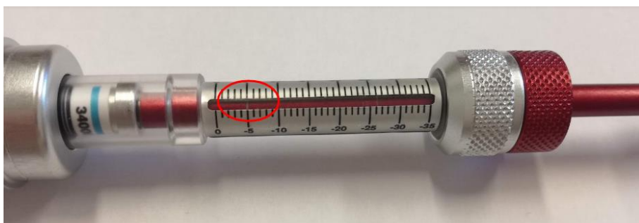
Figura 3.25 - Posizionamento del pistone alla lunghezza desiderata.
