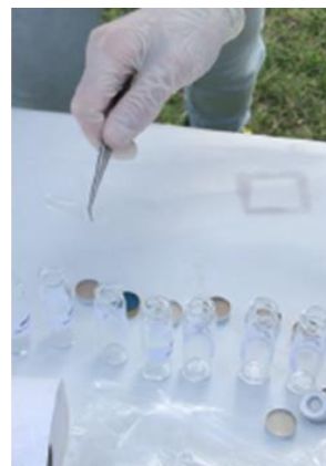
Figura 4.11 - Esempio suddivisione del film di PE esposto in campo per l'analisi in laboratorio.
