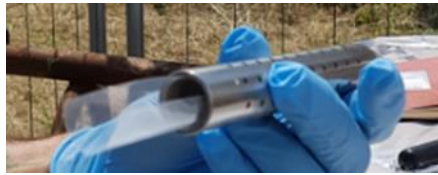
Figura 4.5 - Esempio campionatore per inserimento manuale.
