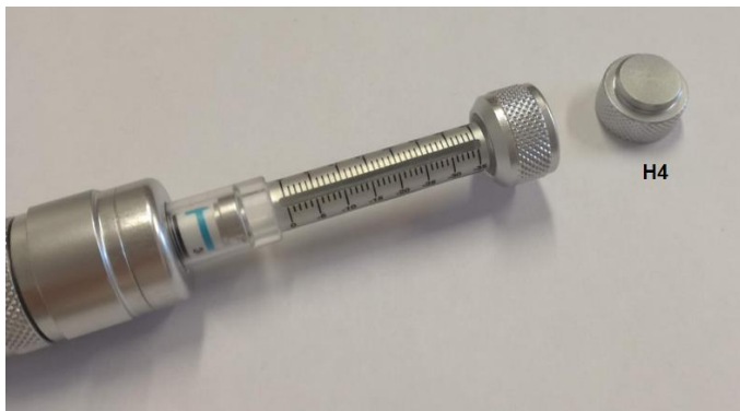
Figura 3.15 - Rimozione del tappo del supporto.
