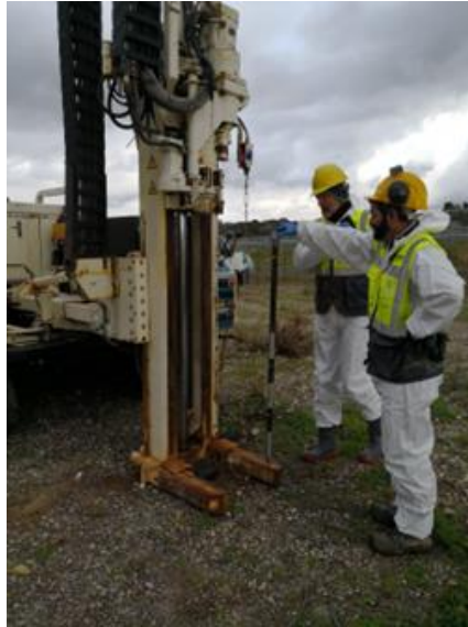
Figura 4.7 - Esempio di inserimento con geoprobe.
