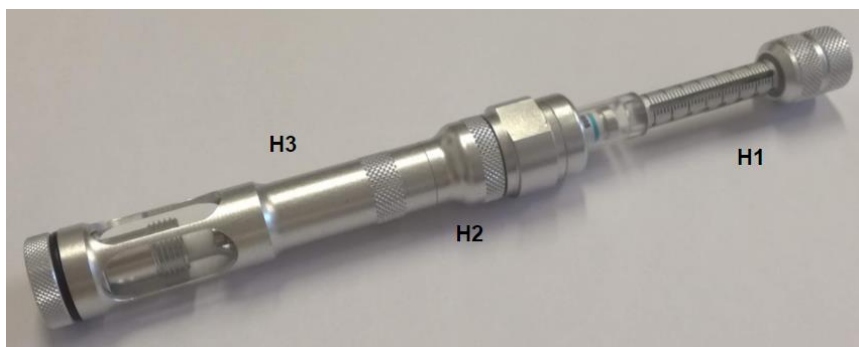
Figura 3.13 - Passaggio 3 per l'installazione della fibra: reinserire la parte H1 nel supporto H3.
