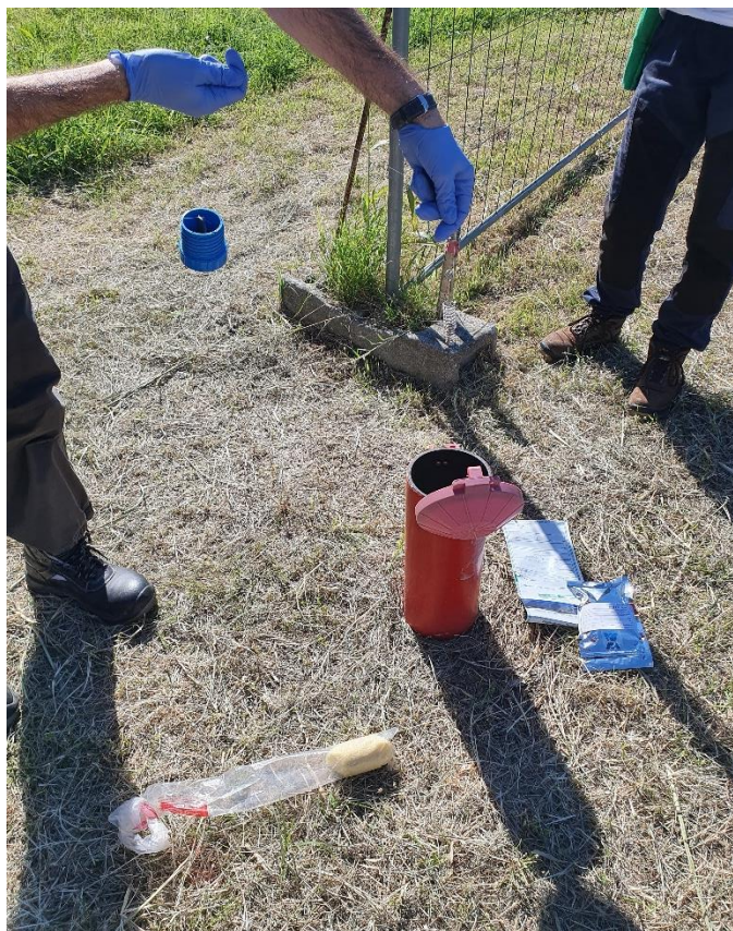
Figura 3.3 - Posizionamento del campionatore WMS e del cilindro di spugna avvolto in una guaina di materiale plastico.
