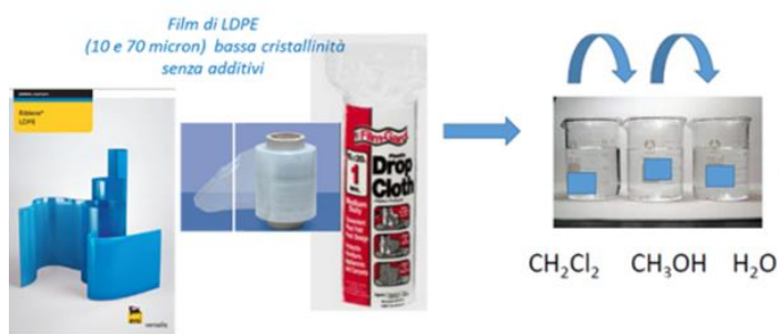
Figura 4.2 - Schema di lavaggio dei film di PE.
