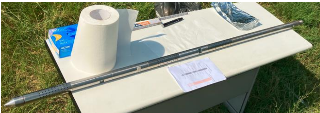
Figura 4.6 - Esempio campionatore multilivello per inserimento con geoprobe.
