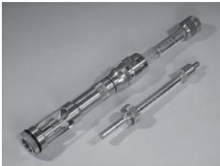
Figura 3.5 - Esempio di struttura di supporto della fibra.
