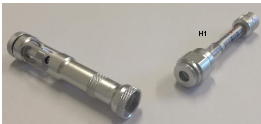
Figura 3.11 - Passaggio 1 per l'installazione della fibra: svitare la parte H1 dal corpo del supporto.
