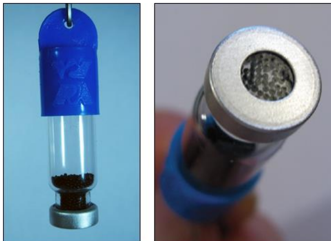
Figura 3.1 - Campionatore Waterloo Membrane Sampler™ caratterizzato dall'utilizzo di un tappo con membrana in polidimetilsilossano (SIREM).
