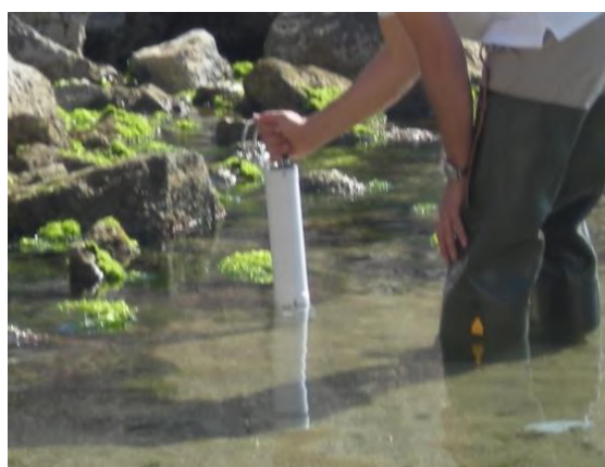
Fig 13.3 - misura dei parametri chimico-fisici con sonda multiparametrica
