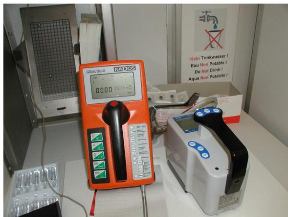
*figura3: esempio di contaminometro e camera a ionizzazione*
