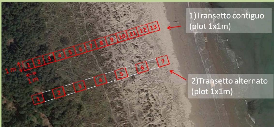
Schema rappresentativo del campionamento della vegetazione tramite transetto di plot contigui ed alternati. Le dimensioni dei plot non sono in scala rispetto all'immagine.
