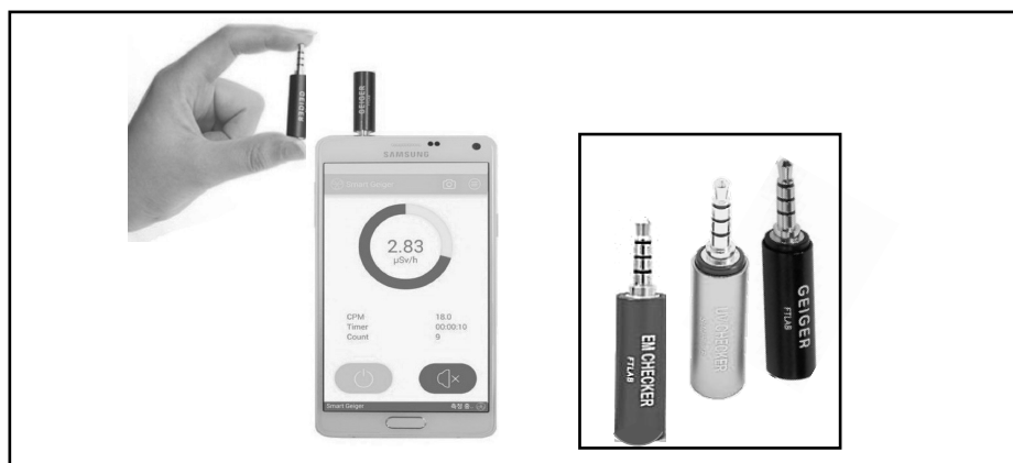
Figura 3: Cellulare con sonda innestata usando il connettore jack audio; a dx diversi tipi di sonde con connettore jack per cellulare, in progressione: misuratore di elettromog, rivelatore solare di UVA e UVB, sonda smart Geiger per la misurazione di radiazioni gamma e raggi X.
