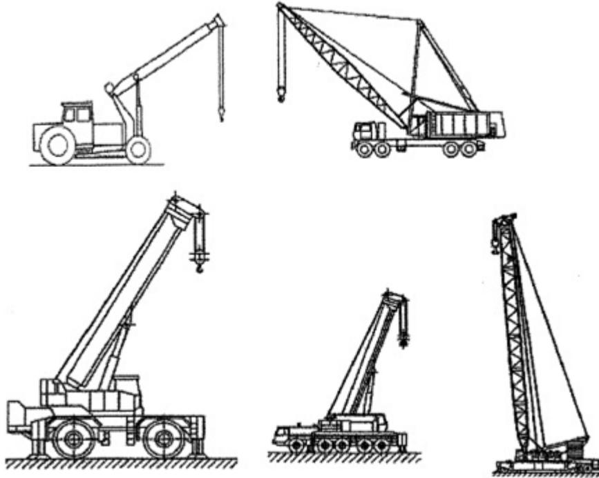
**Gru mobili autocarrate e semoventi su ruote con braccio telescopico o tralicciato ed eventuale falcone fisso.**
