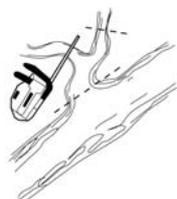
Dopo aver abbattuto un albero si procede alla sramatura. Questa è un'operazione rischiosa perché è facile che accadano contraccolpi. Bisogna tenere sempre sotto controllo la punta della lama, in modo da non toccare i rami nascosti con il settore a rischio della lama.
