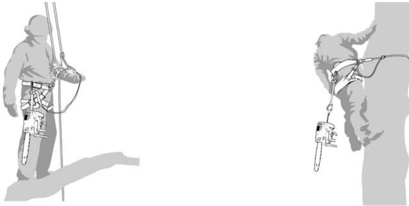
Fig. 3 – Esempi di attacchi della motosega all'imbracatura dell'operatore
