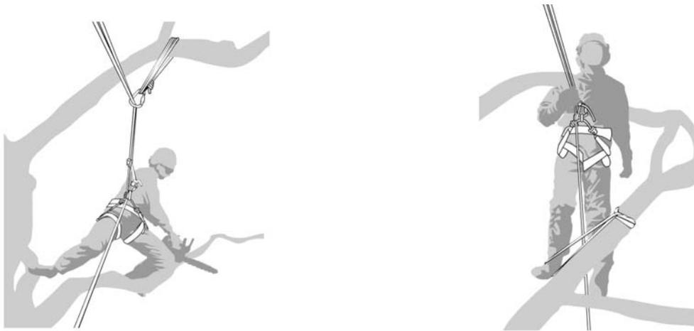
Fig. 4 – Esempi di uso di funi e ganci per assicurare una posizione sicura
