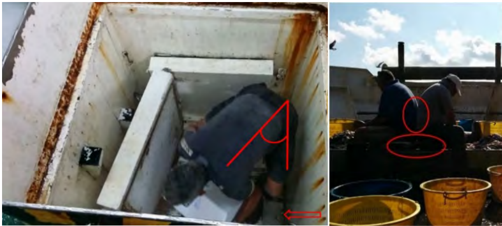
Fig. 16 (sinistra) e fig. 17 (destra): le immagini mostrano alcuni miglioramenti adottati dai membri dell'equipaggio: un pallet per ridurre la dislocazione verticale (freccia rossa) e il posizionamento del carico a 45° per ridurre la torsione del tronco. Parte dell'equipaggio, dove permesso dalle dimensioni della barca, effettuano la cernita seduti sul pianale di poppa, in rosso sono evidenziate le due soluzioni adottate dai pescatori: uno sgabello per una seduta più comoda ed il supporto reciproco della schiena per scaricare il carico
