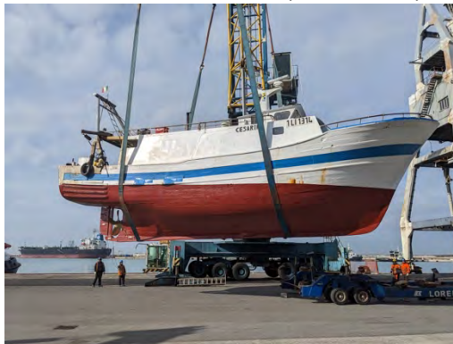
Fig. 2 Peschereccio in fase di varo mediante la movimentazione con gru portuale
