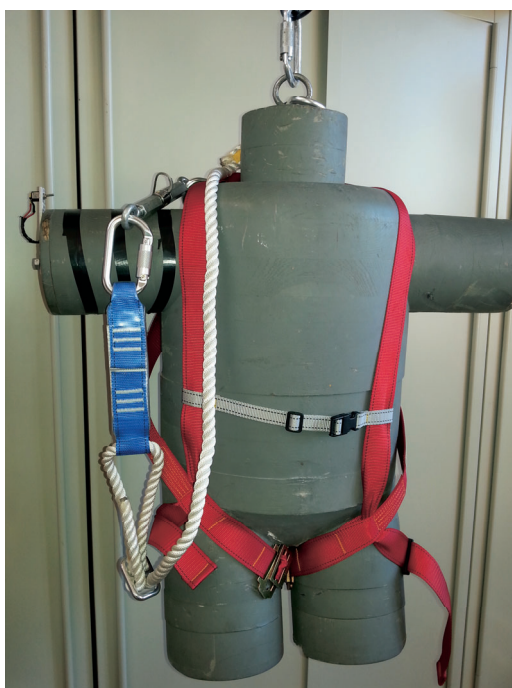
Figura 4.2.2.2-6 Torso strumentato con sistema di arresto caduta I
