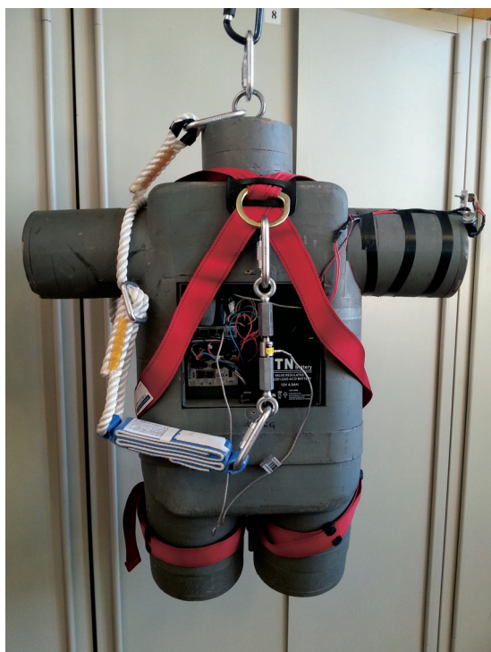
Figura 4.2.1-2 Vista posteriore del torso di prova
