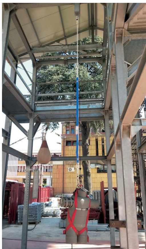
Figura 4.2.1-9 Posizione finale (Fase 4 - si noti l'assorbitore svolto)
