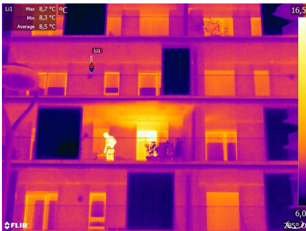
Esempio di facciata con correzione dei ponti termici. La soletta in c.a. del balcone ha un elemento di taglio termico e quindi superficialmente la temperatura è omogenea ( \Delta T < 1 \text{ }^\circ\text{C} ) come mostrato dai valori indicati dalla linea (massimo e minimo) - edificio realizzato a Milano – misure inverno 2022/23
