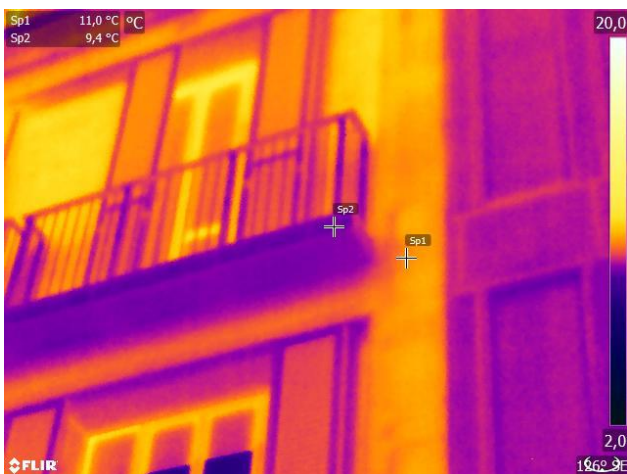
Esempio di facciata con correzione dei ponti termici. La soletta in c.a. del balcone ha un elemento di taglio termico e quindi la soletta del balcone è alla temperatura dell'aria esterna - edificio realizzato a Milano – misure inverno 2022/23
