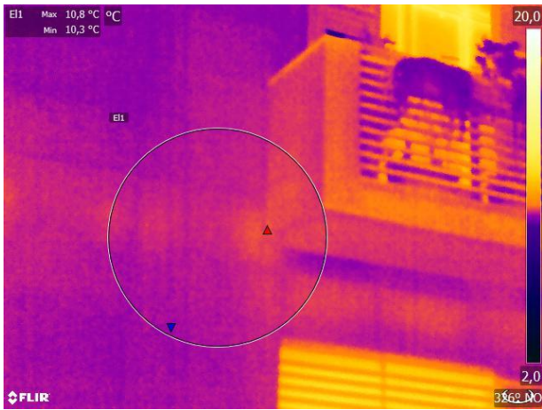
Esempio di facciata con correzione dei ponti termici. La soletta in c.a. del balcone ha un elemento di taglio termico e quindi superficialmente la temperatura è omogenea ( \Delta T < 1 \text{ }^\circ\text{C} ) come mostrato dai valori indicati nell'area circolare (massimo e minimo) - edificio realizzato a Milano – misure inverno 2022/23
