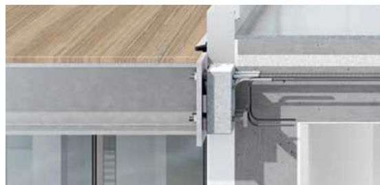
Elemento a taglio termico per struttura cemento armato/acciaio - Isokorb® T tipo SK
