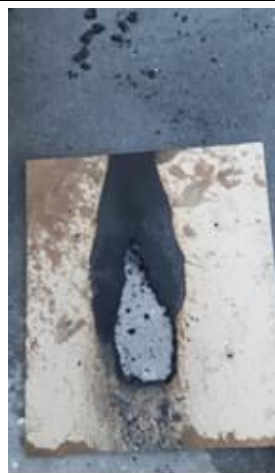
Figura 16 – Immagini da test n. 5: a (camera prove con campione installato, prima dell'inizio del test), b (immagine dall'esecuzione del test), c (camera prove con campione dopo il termine del test), d (campione di copertura dopo il termine del test, estratto dalla camera prove)
