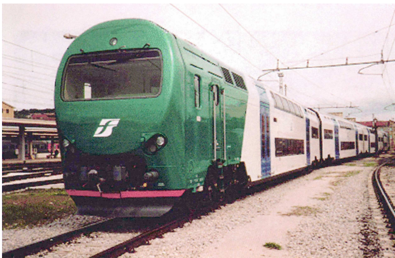
Configurazione di testa e di coda dell'ALE 506/426 - Treno Alta Frenquenza (TAF)
