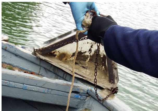
Figura 10: Retino a maglia fine di forma triangolare, con bordi rinforzati, per il prelievo del sedimento (foto relativa al prelievo nella stazione 3).
