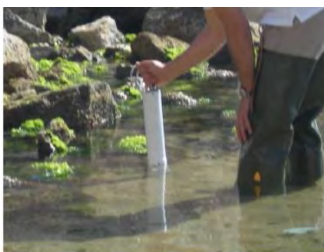
Fig 12.3 - Misura dei parametri chimico-fisici con sonda multiparametrica
