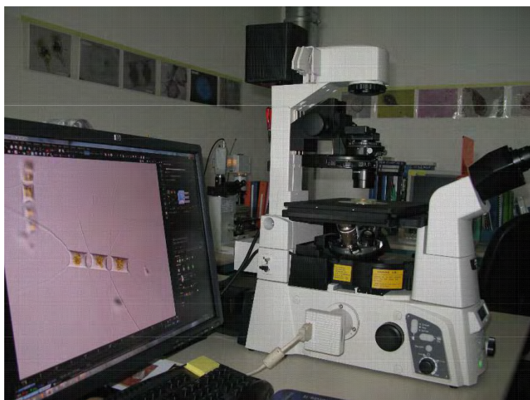
Figura 4.8 – Microscopio Nikon Eclipse Ti utilizzato per l'identificazione ed il conteggio delle microalghe
