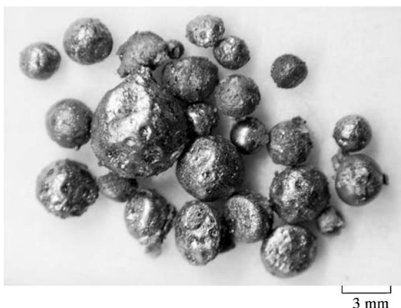
Figura 24 Particelle di Fe-C-P prodotte da scorie siderurgiche
