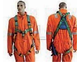
L'imbracatura di sicurezza protegge dalle cadute e deve essere sempre utilizzata quando si lavora ad altezze superiori ai 2 metri dal pavimento o quando si lavora fuori bordo. Assicurarsi che la cima di trattenuta sia della lunghezza minima e che sia collegata ad un punto sicuro. Ispezionarla dopo ogni caduta e rimpiazzare se danneggiata.
