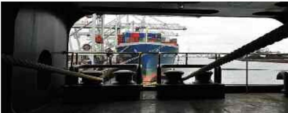
Moltissimi sono gli incidenti che si sono verificati durante il maneggio dei cavi di ormeggio, quando essi si sono rotti (53%) o sono scivolati dalle bitte o dai tamburi dei verricelli (42%) o a causa dell'avaria dell'apparecchiatura (5%).
