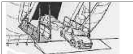
nire una protezione dai veicoli in movimento. Se non è possibile predisporre un passaggio pedonale con protezioni laterali, si deve attrezzare un passaggio pedonale che sia chiaramente indicato e segnalato su un lato della rampa.
