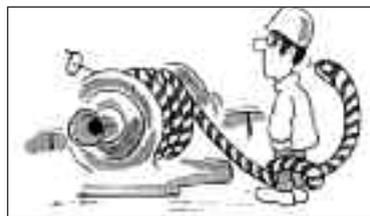
Quando si dà volta ad un cavo sintetico, NON usare solo una "figura a 8" per voltarlo. Dare due volte (non di più) intorno alla bitta davanti a quella su cui si inizierà a voltare a "8". Con questo sistema si avrà un miglior controllo del cavo e sarà più facile e più sicuro maneggiarlo.
