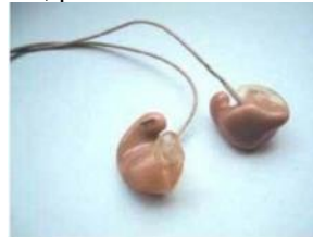
Figura 5. Monitor intrauricolari personalizzati (Fonte: Linee guida europee [1]).
