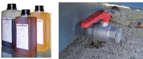
Figura 4.2: Prelievo di campioni di olio dal trasformatore
