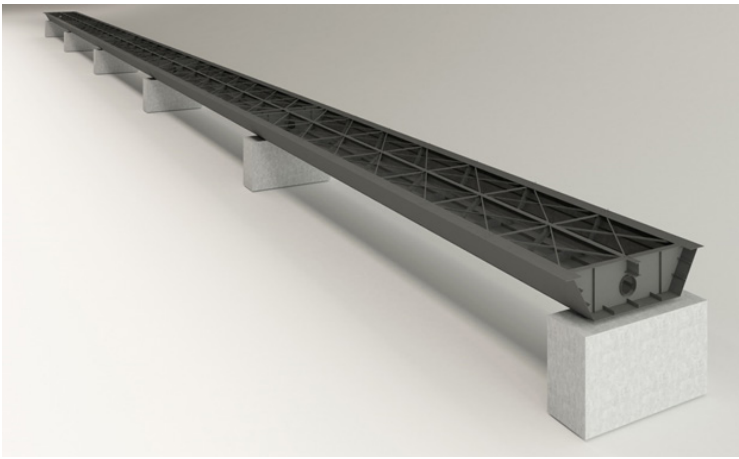
Figura 4.37 – Modello 3D soluzione di trave a cassone con schema a trave continua
