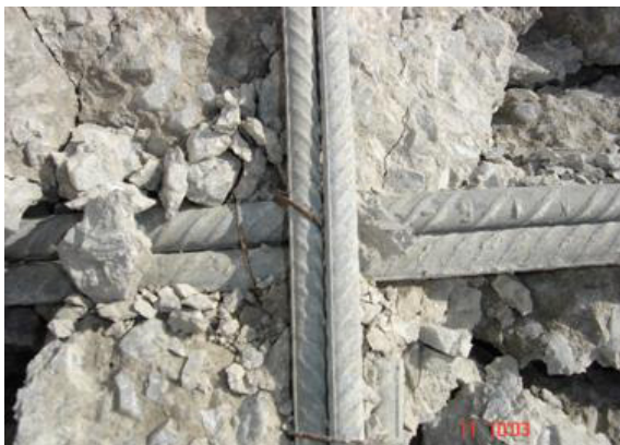
Figura 6.14 - Port Elisabeth (Sud Africa) - Armature zincate a caldo dopo oltre 40 anni di servizio (1964-2005). Ponte pedonale a pochi metri dal mare abbattuto per cessata utilità. Questa particolare circostanza ha consentito di verificare che le armature zincate erano ancora in perfetto stato
