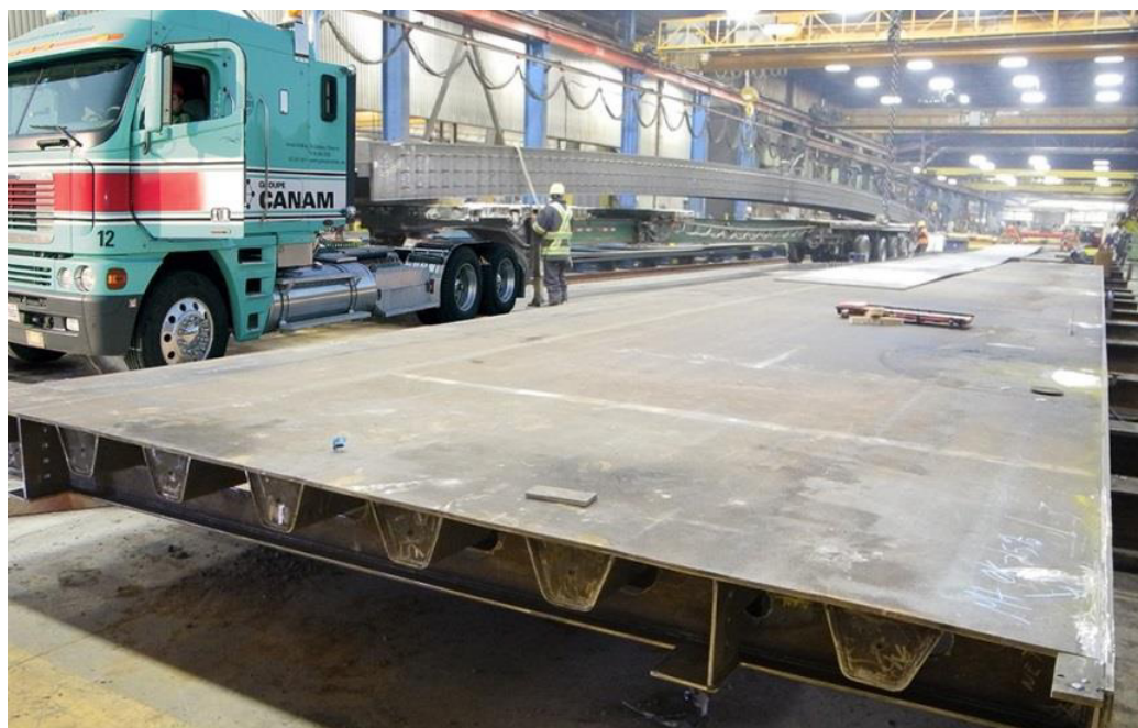
Figura 4.100 - Esempio di lastra a comportamento ortotropo
