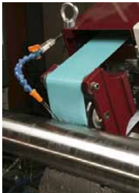
Figura 2 - Esempio di attrezzatura per la superfinitura dei pezzi [1]
