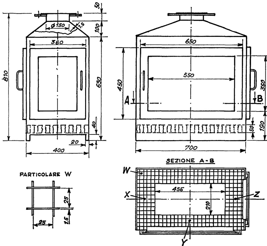
X, Y, Z 5 cm sopra la griglia Posizioni per la misurazione della velocità dell'aria.
