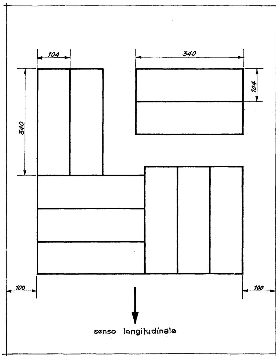
Fig. 5 — *Prelievo dei provini dal campione da analizzare*
