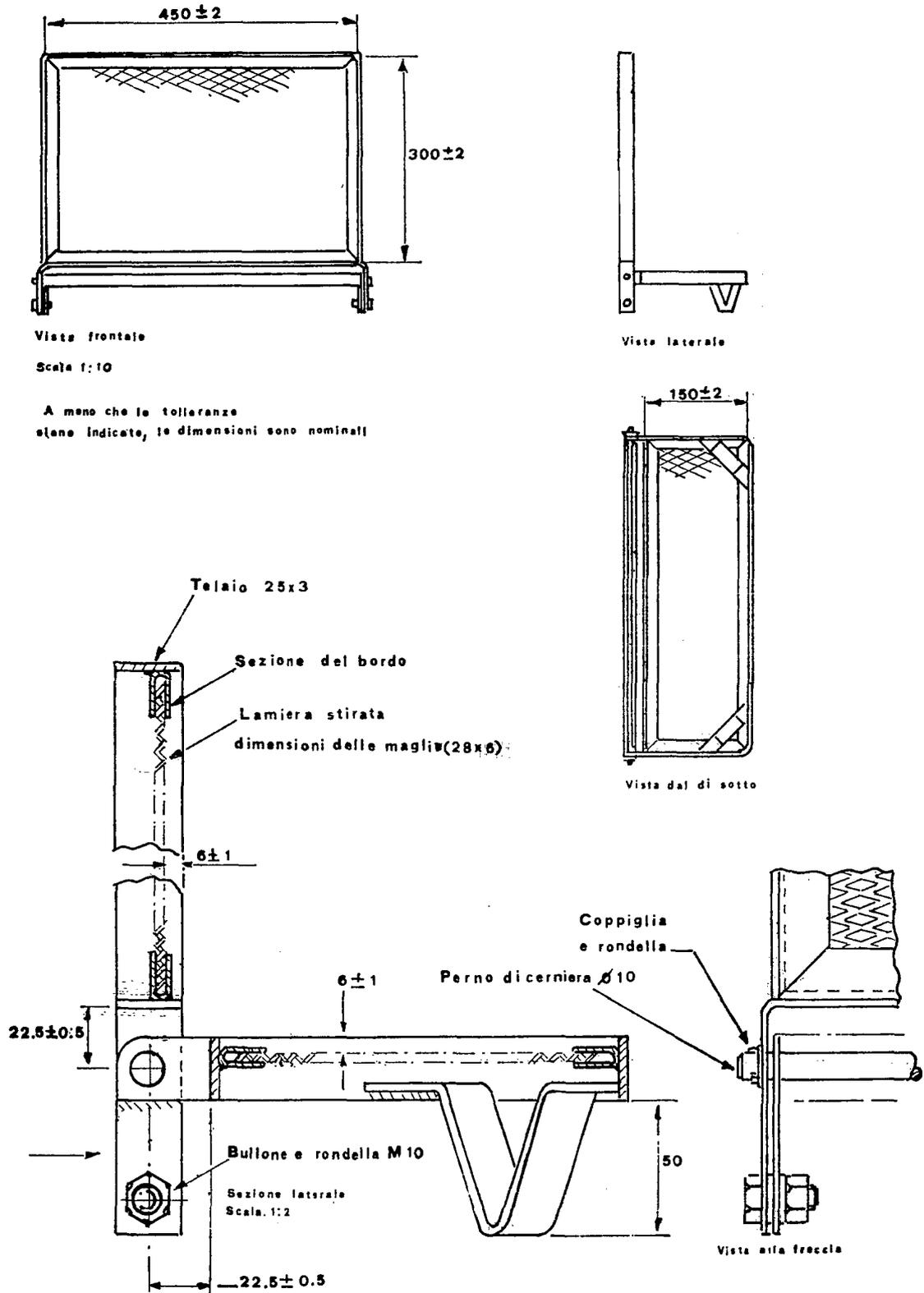
Tutte le dimensioni sono in millimetri. Tutte le parti sono d'acciaio.
