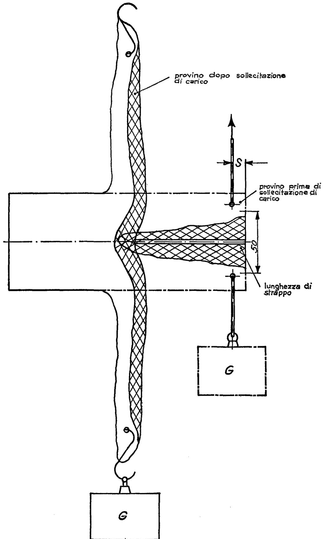
Fig. 6 — Schema della determinazione della lunghezza di strappo
