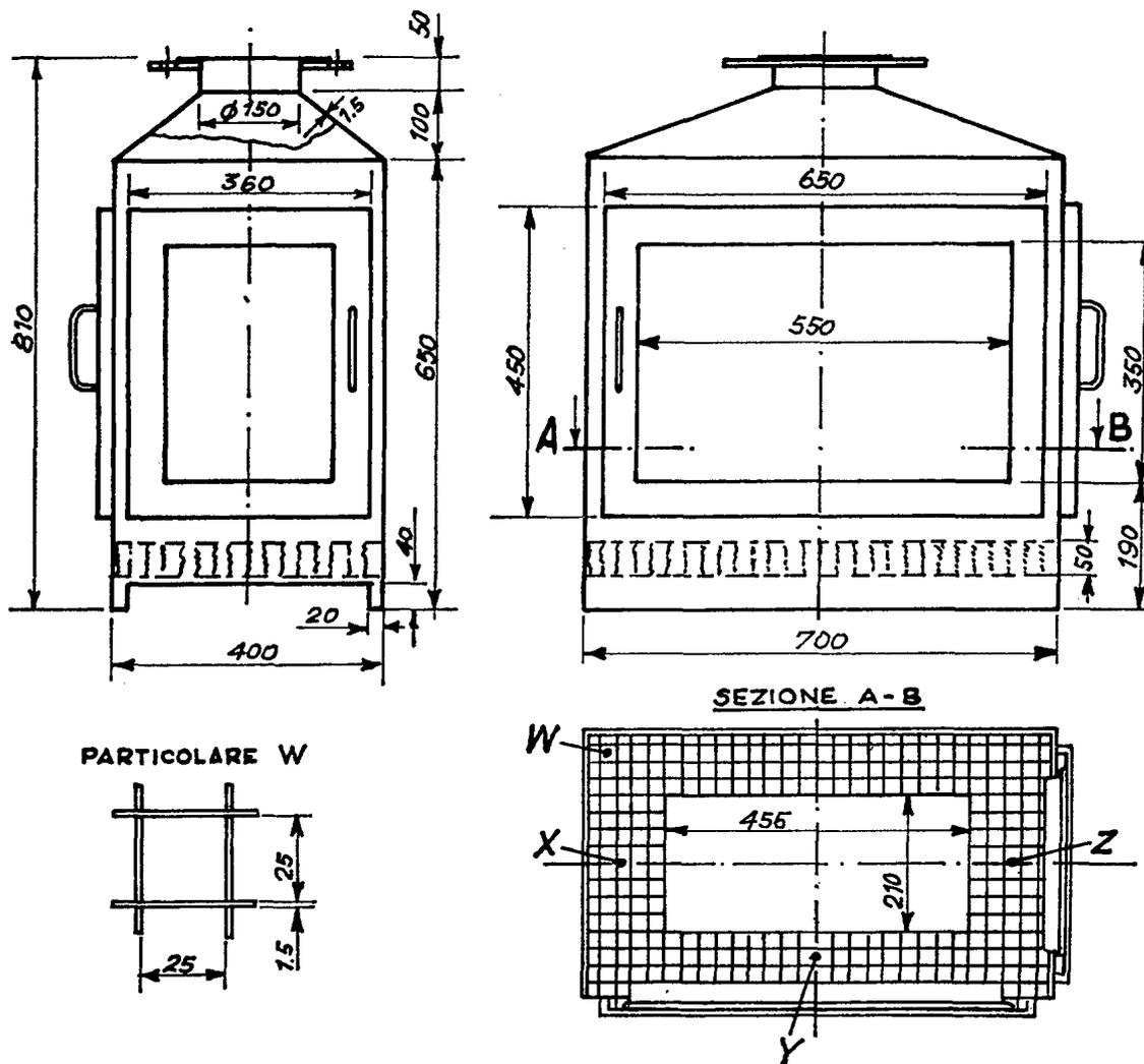
X, Y, Z 5 cm sopra la griglia. Posizioni per la misurazione della velocità dell'aria.
