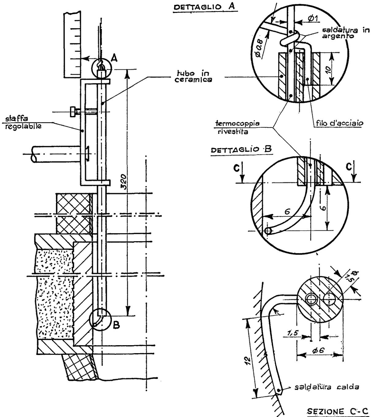
Fig. 4 — Dispositivo di stima per termocoppia rivestita
