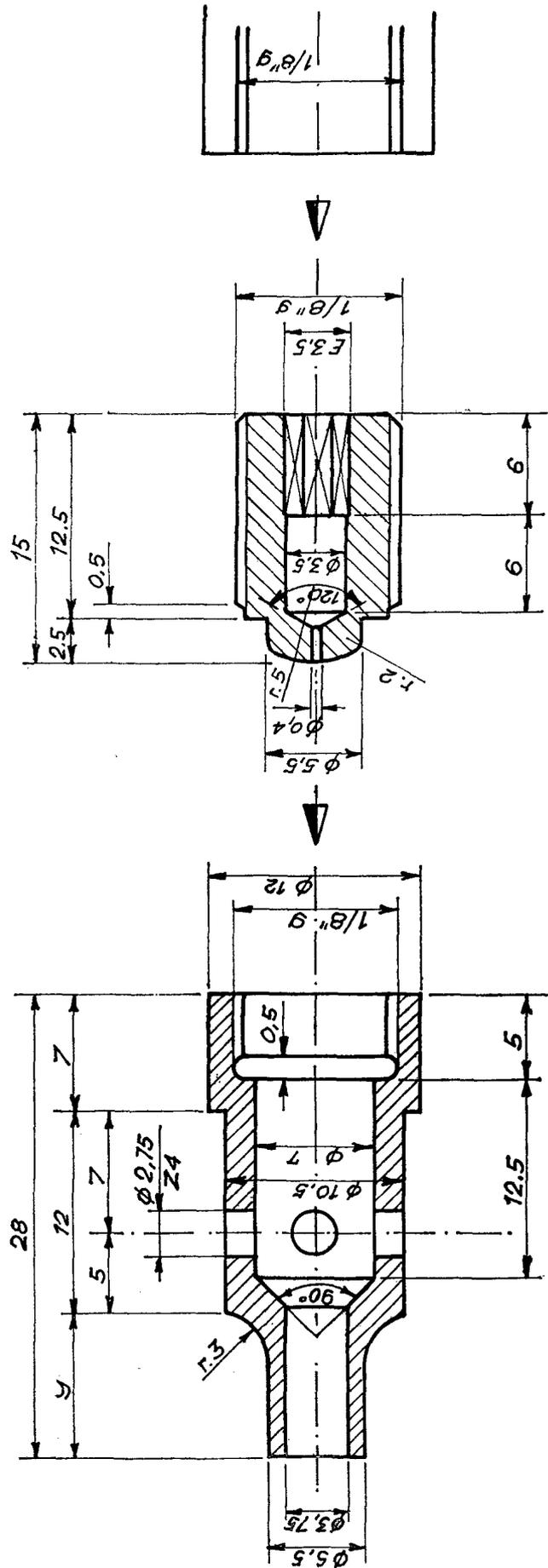
Fig. 5 — Bruciatore fiamma pilota ([materiale] ottone)
