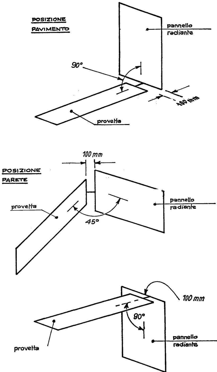
Fig. 3 — Posizioni relative pannello-provetta
