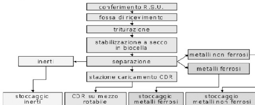
Schema a blocchi dell'impianto di produzione del combustibile
