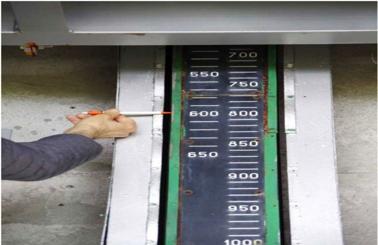
Figura 14 - Ulteriore particolare delle scale graduate. A dx scala graduata di escursione del contrappeso della fune traente superiore; posizione limite dell'asta: 650 cm, segni di sfregamento tra l'indice 600 cm e l'indice 550 cm (fonte Digifema).
