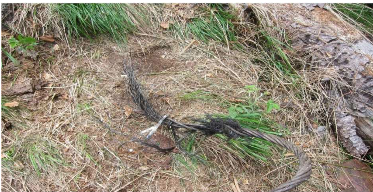
Figura 2 - Fune traente superiore nella zona di rottura (fonte Digifema).
