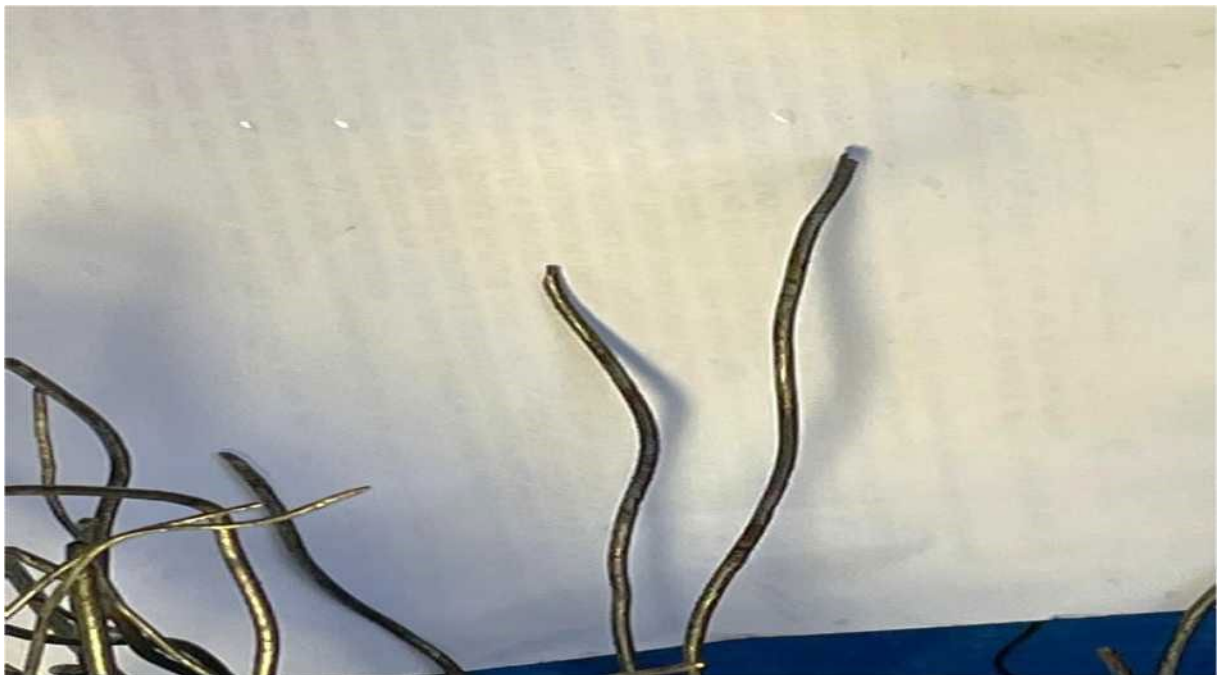
Figura 4 - Fune traente superiore, particolare dei fili con rottura a becco di flauto e tracce di ossidazione (fonte internet).
