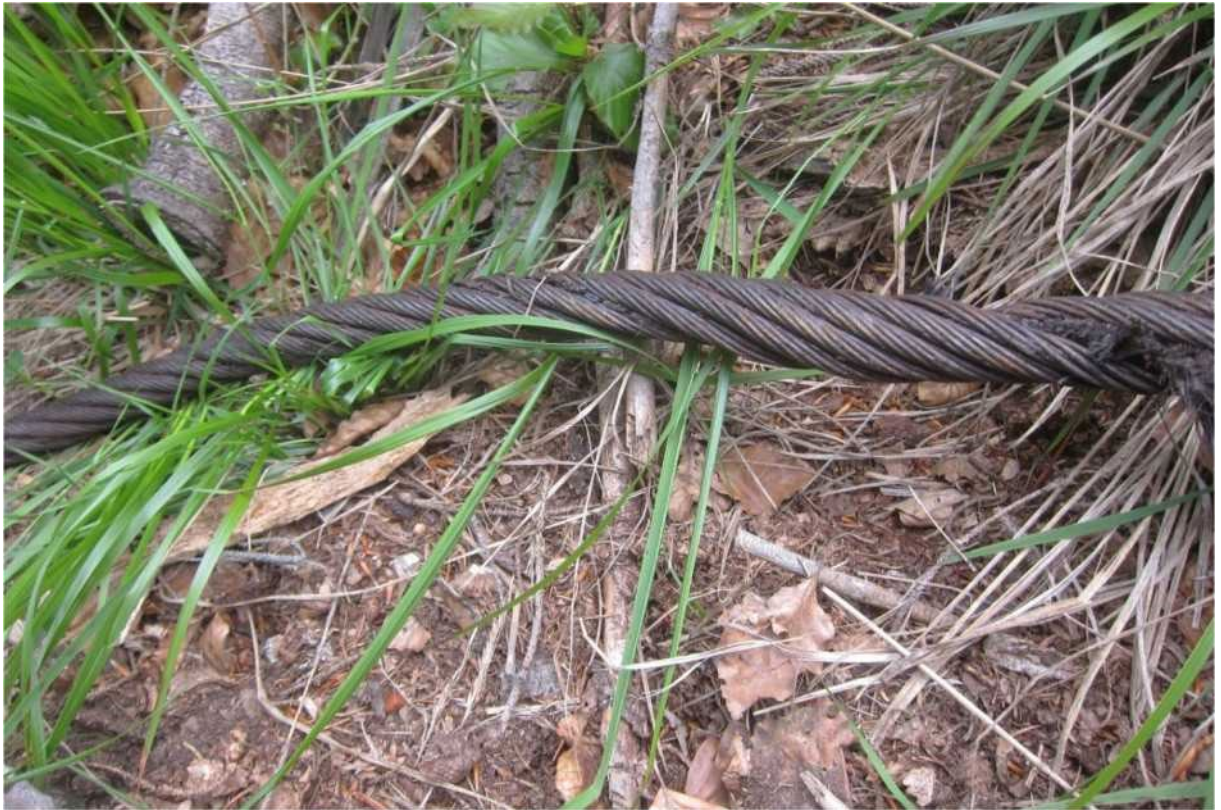
Figura 5 - Fune traente superiore precedente la zona di rottura; si notano l'allentatura dei trefoli nel passo e tracce di ossidazione (fonte Digifema).
