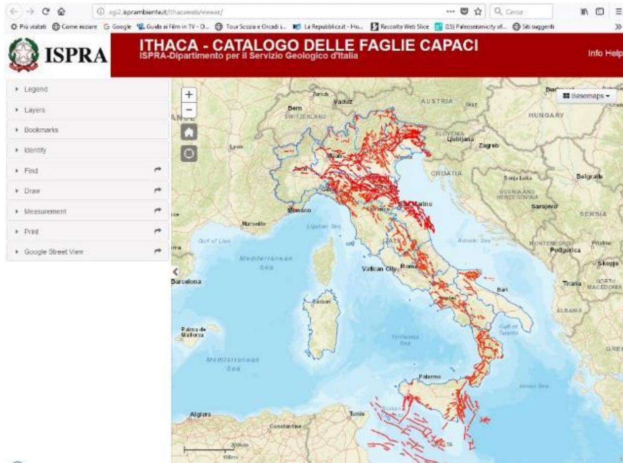
Fonte: sito web di [ITHACA](http://ithaca.isprambiente.it) (Italy HAZard from CAPable faults), Sono rappresentate le Faglie Capaci (attivate negli ultimi 125.000 anni) e Potenzialmente Capaci (attive nel Quaternario, ossia c.a. ultimi 2 Milioni di anni) note in letteratura in Italia.
