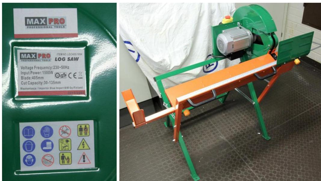
Il prodotto, marca MAX PRO, Mod. LG405 / 1094, 2011/2261, è stato sottoposto alla procedura di ritiro obbligatorio dal mercato perché non conforme alla Direttiva 2006/42/CE Macchine ed alla norma tecnica EN 1870.
