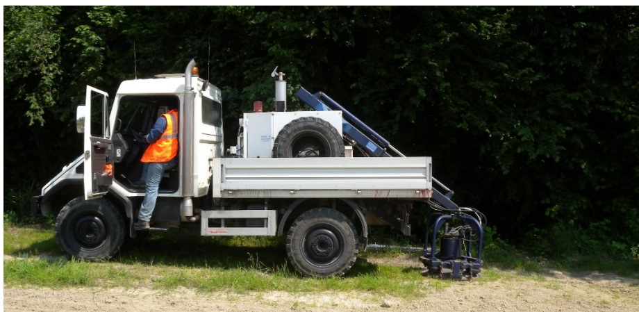
Figura 2.1-4: Vibroseis - Mezzi in attesa, arrivati nella posazione di energizzazione prdefinita, la ruote posteriori alzate permettono una migliore coesione a terra della piastra che sarà poi messa in vibrazione da un sistema elettro-idraulico. [Foto DGSUNMIG].
