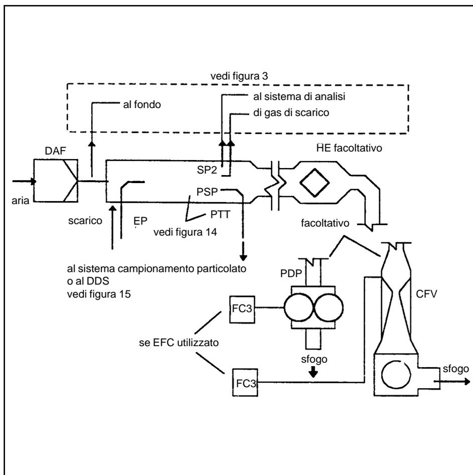
Tutto il flusso di gas di scarico grezzo viene miscelato nella galleria di diluizione DT con l'aria di diluizione.
