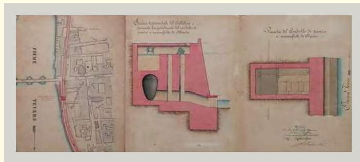
Collettore sinistro, sezione trasversale e pianta del manufatto di chiusa per lo sbocco provvisorio in corrispondenza con ponte Sisto, 1882, 23 x 69 cm.
