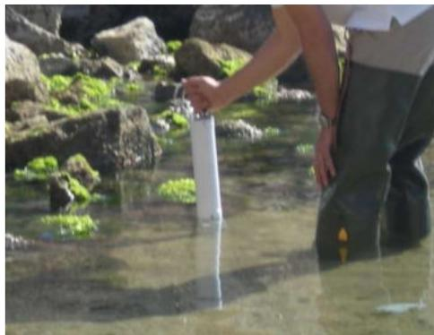
**Figura 12.3** - Misura dei parametri chimico-fisici con sonda multiparametrica
