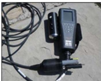
**Figura 6.3** - *Sonda da campo multiparametrica*
