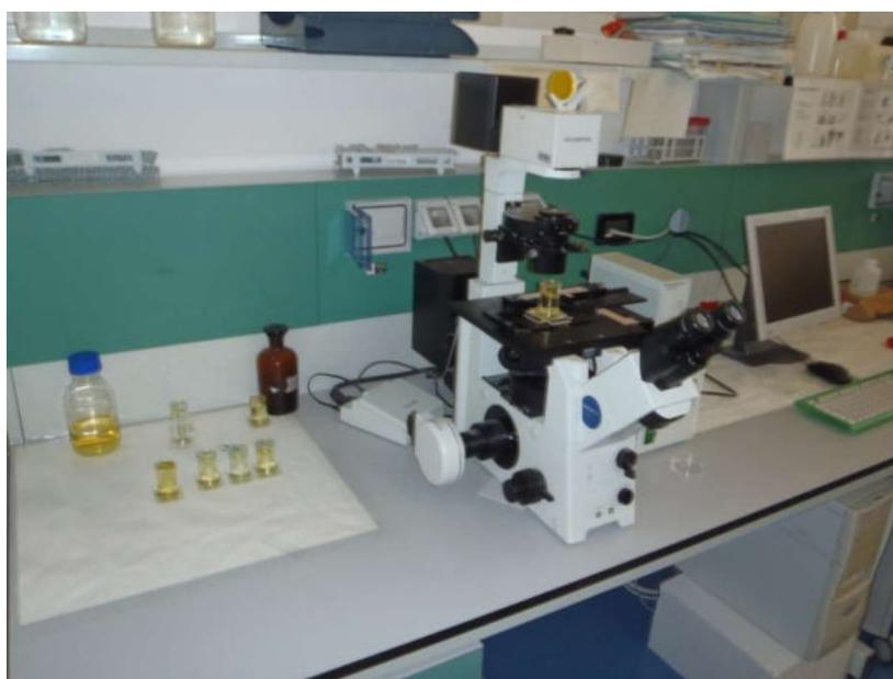
**Figura 12.4** - Microscopio ottico invertito e camere di sedimentazione
