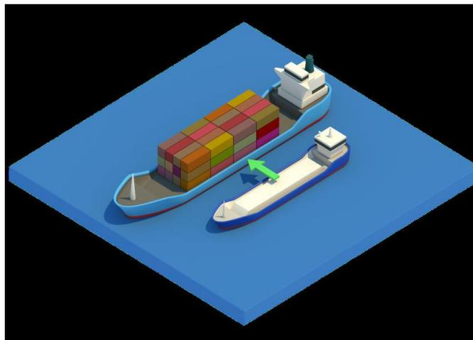
Tra i principali vantaggi di questo tipo di trasferimento vi è la possibilità di operare in mare anche senza dover entrare in porto se le condizioni metereologiche e del moto ondoso lo consentono, oltre alla possibilità di movimentare ingenti volumi di prodotto in tempi veloci.
