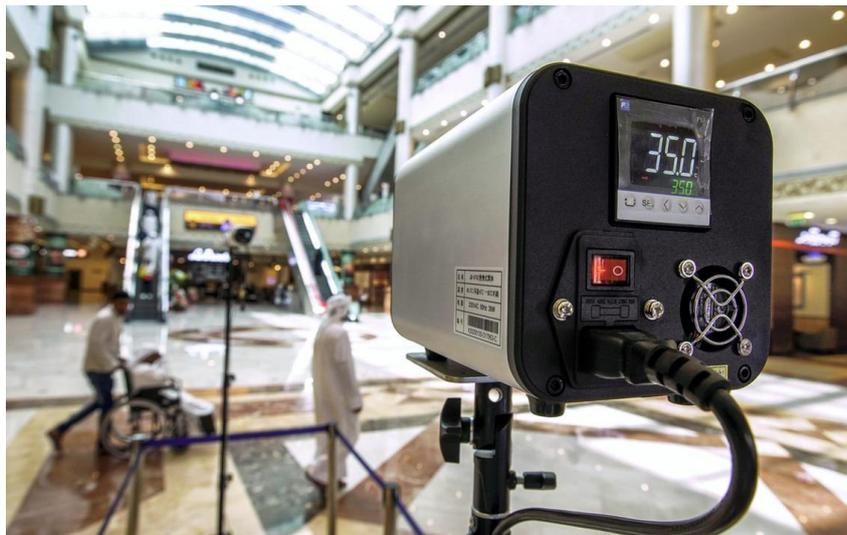
Fig. 1 – Telecamera termica fissa - EN 60601-1:2007 | EN 80601-2-59:2009
