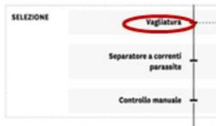
*Nel processo di vagliatura, i rifiuti da imballaggio sono cerniti tramite nastri trasportatori a maglia larga, che raccolgono nel sottovaglio piccole frazioni di materiali, tra cui quelle di alluminio.*
