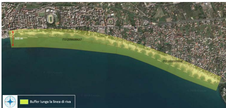
Figura 4: Alterazioni morfologiche - buffer di 500m: presenza di barriere emerse (opere longitudinali) per il 100% delle acque di balneazione.
