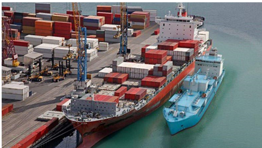
Fig. 4.2: Bunkeraggio STS (tratto da Linee Guida EMSA)
