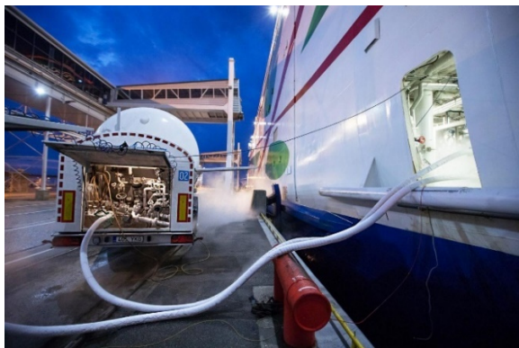
Fig. 4.1: Bunkeraggio TTS (tratto da Linee Guida EMSA)
