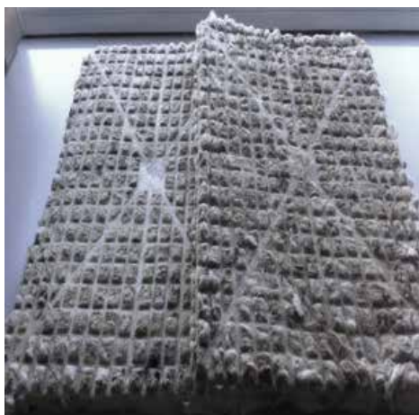
Figura 1. Pannelli per isolamento termico e acustico in lana di scarto e canapa tecnica
