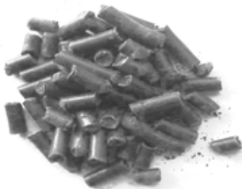
Figura 2. Pellet di fertilizzante a base di lana di scarto idrolizzata
