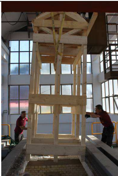
12/5/2015 – figura 24 Posizionamento della centina nel forno orizzontale
