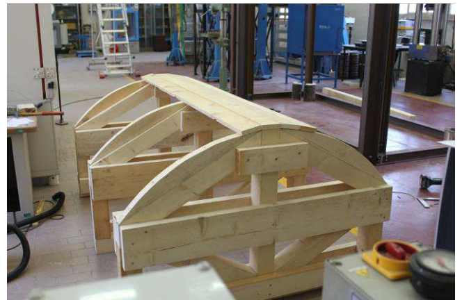
4/5/2015 – figura 15 Prova di accoppiamento di tre centine
