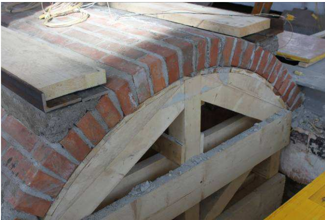
26/5/2015 – figura 42 Sistema di ripartizione del carico concentrato (profilo a L, piatto in acciaio e tavolone di legno)
