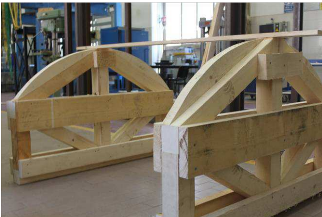
4/5/2015 – figura 14 Prova di accoppiamento di due centine
