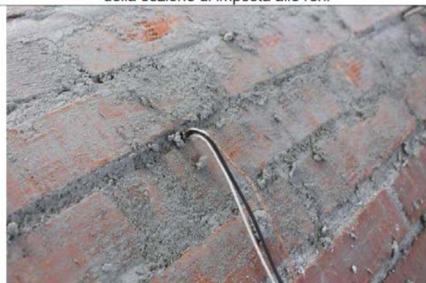
18/5/2015 – figura 35 Particolare dei cavi compensati delle termocoppie interne in corrispondenza della sezione di applicazione del carico (n. 3 per sezione di misura)
