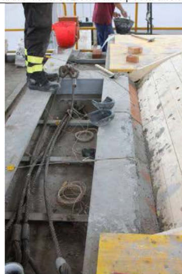
15/5/2015 – figura 33 Posizionamento delle termocoppie interne in corrispondenza della sezione di imposta alle reni
