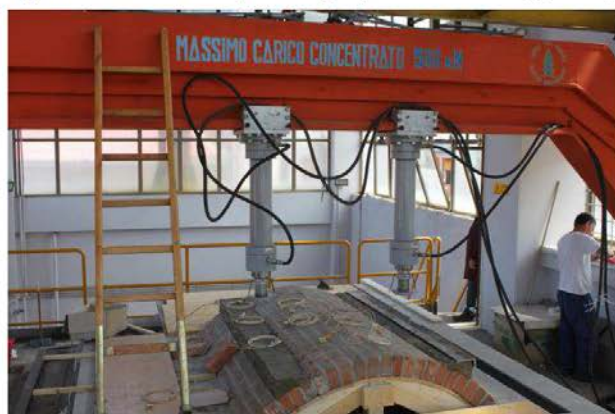
21/5/2015 – figura 41 Posizionamento di prova dei martinetti del sistema di carico (spinta su trave di contrasto)
