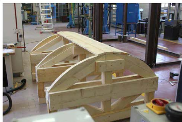
4/5/2015 – figura 15 Prova di accoppiamento di tre centine
