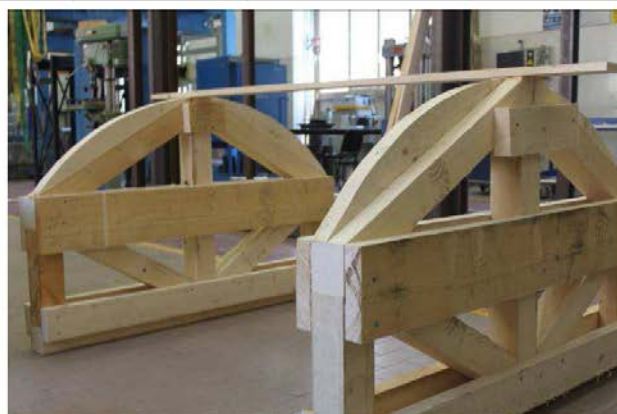
4/5/2015 – figura 14 Prova di accoppiamento di due centine
