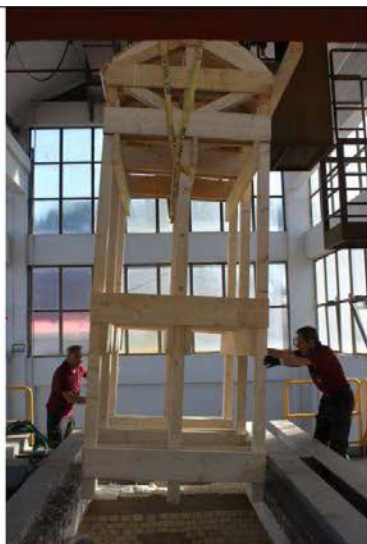
12/5/2015 – figura 24 Posizionamento della centina nel forno orizzontale
