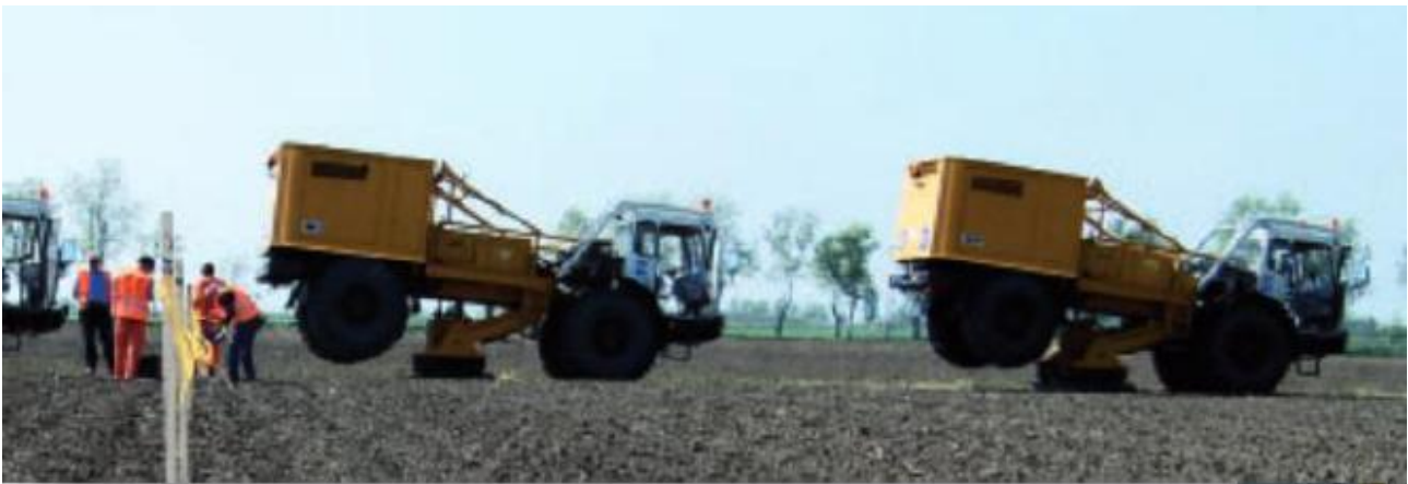
Figura 3.1-4: Vibroseis - Mezzi in attesa, arrivati nella posazione di energizzazione prdefinita, la ruote posteriori alzate permettono una migliore coesione a terra della piastra che sarà poi messa in vibrazione da un sistema elettro-idraulico. [Foto DGSUNMIG].
