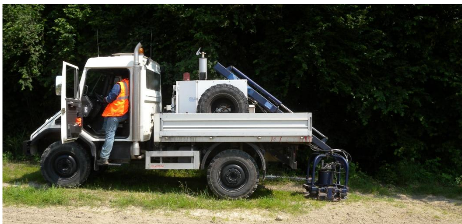
Figura 3.1-4: Vibroseis - Mezzi in attesa, arrivati nella posazione di energizzazione prdefinita, la ruote posteriori alzate permettono una migliore coesione a terra della piastra che sarà poi messa in vibrazione da un sistema elettro-idraulico. [Foto DGSUNMIG].
