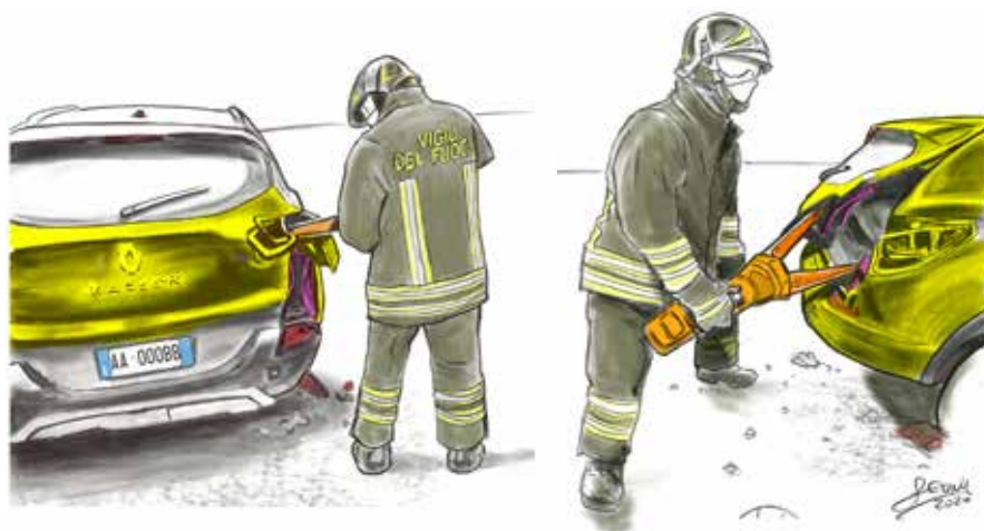
Uso del divaricatore tra il portellone posteriore (un elemento mobile / elastico) e il telaio (elemento fisso / plastico)
