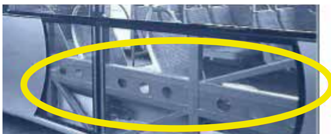
particolare del rinforzo laterale
