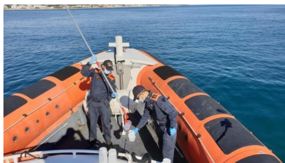
Figura 5 - Attività di campionamento. Fasi caratterizzanti il prelievo dei campioni di acqua di mare: raggiungimento della stazione di campionamento mediante mezzo nautico (prime due foto in alto), raccolta del campione direttamente nel contenitore idoneo mediante utilizzo di asta telescopica (foto centrali), recupero del campione e stoccaggio a bordo (ultime due foto in basso).
